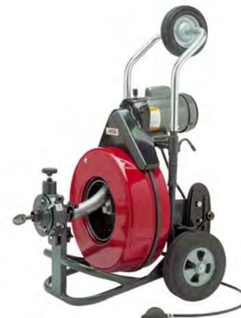
Σπιραλ Ø 16 mm (υπαρχει επισης και Ø 19 mm) μηκους 30 m (επεκτασιμο εως τα 60 m), ιδιαιτερα ανθεκτικο, περιελιγμενο σε μεταλλικη "ψυχη" με 49 συρματα και θερμικα επεξεργασμενο.
