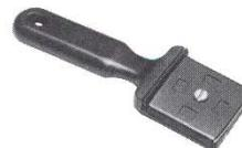
Stabi-Rohre sind auf dem äußeren Rohrumfang mit einer Alu-Ummantelung ausgerüstet. Dieser Alu-Mantel muss vor dem Verschweißen innerhalb der Schweißzone abgeschält werden. Schälwerkzeuge bis d = 63 mm sind für jeweils zwei Rohrabmessungen bestimmt. Ab d = 75 mm jeweils für eine Rohrdimension. Die Schälwerkzeuge ab 50 mm Durchmesser sind mit Drehgriffen ausgerüstet.
