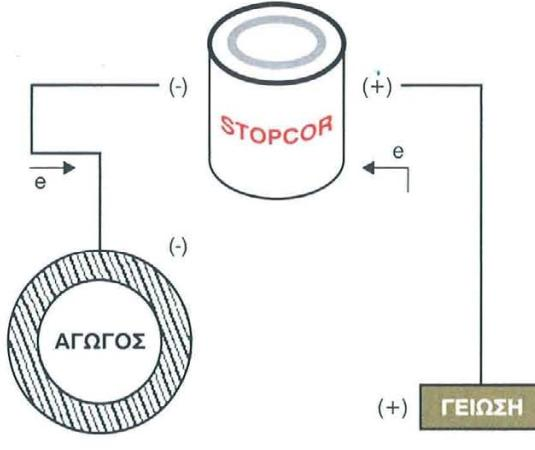
Η μέθοδος καθοδικής προστασίας με την αυτόνομη συσκευή STOPCOR έχει εφαρμογή σε όλες τις εγκαταστάσεις όπου κυκλοφορούν υγρά καθώς επίσης σε βάσεις και οπλισμούς μεταλλικών κτηρίων, γεφυρών, πυλώνων, αγωγών, δεξαμενών και γενικά επιφανειών με προδιάθεση στην ηλεκτροχημική διάβρωση, καθώς επίσης και σε όλες τις μηχανές εσωτερικής καύσεως, στροβίλων, εναλλάκτες θερμότητας, συστήματα ψύξεως, θερμάνσεως και τεχνητού κλίματος.
